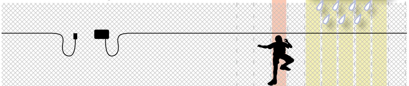
Lorsqu'une cible entre en contact avec la clôture, une signature du signal reçu est établie pour identifier l'impulsion de retour.
