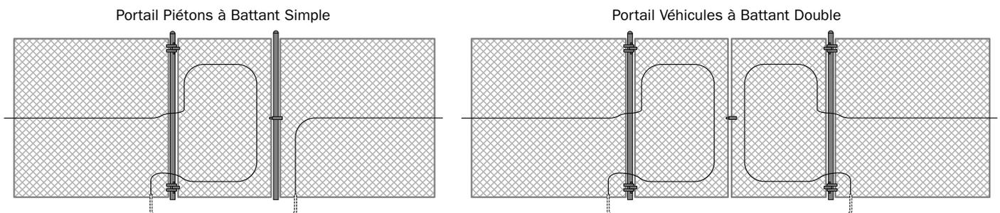
Le câble MicroPoint™ robuste et flexible de l'UniZone peut être facilement monté pour protéger les portails, et résiste aux ouvertures/fermetures répétées. Afin de prévenir les fausses alarmes, les sections de câble aux trottoirs et entrées peuvent être facilement désactivées et réacheminées sous terre, sans qu'il soit nécessaire d'épisser un câble non-sensible.
