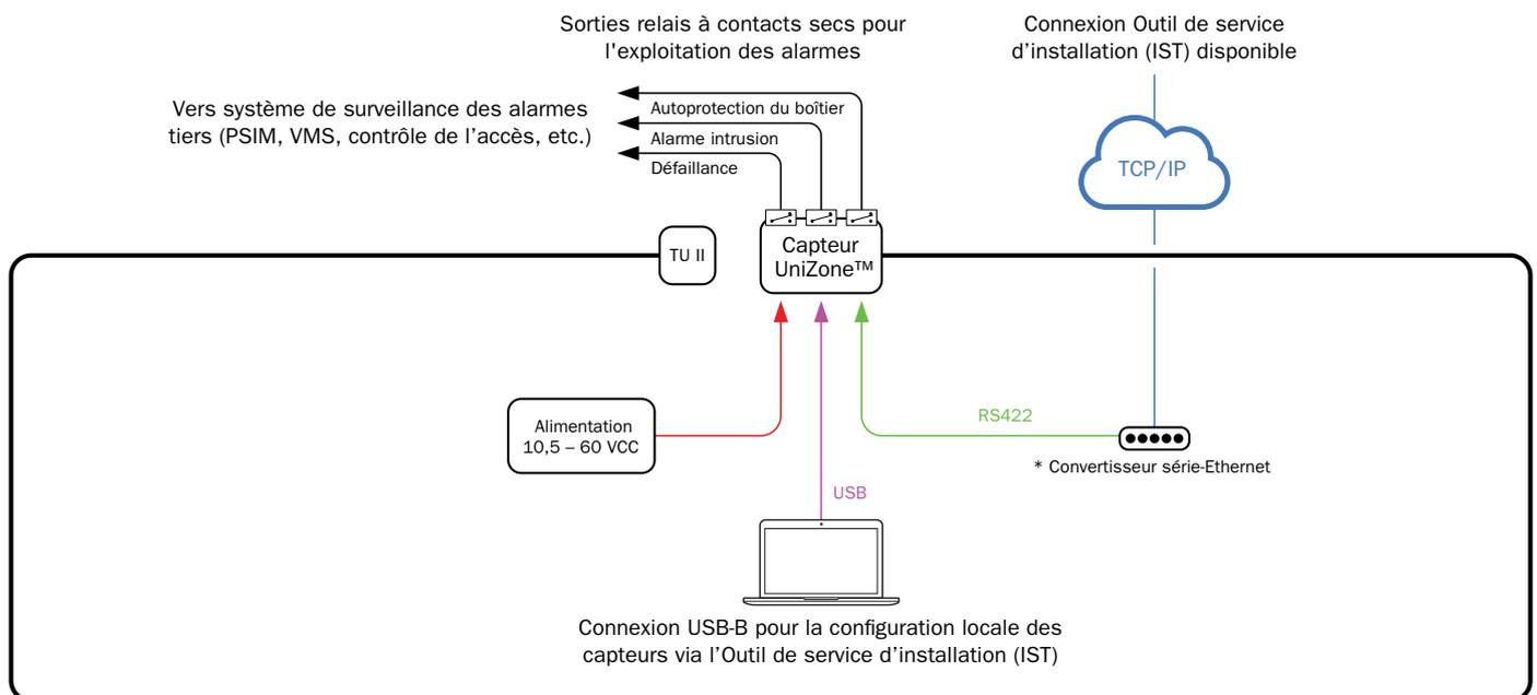
Maximum de 200 Mètres linéaires par Capteur de Détection Sur Clôture UniZone™
