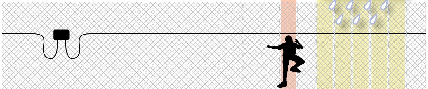
Quando um alvo entra em contato com a cerca, o sinal recebido é analisado para criar um sinal que descreva o pulso refletido. O Processamento de Sinal Digital (DSP) mede a localização e a forma desse pulso. O microprocessador pode diferenciar a forma de uma resposta de um Impacto Pontual (tentativa de corte ou de escalada) em oposição a uma resposta causada por uma Perturbação Distribuída (chuva, vento, tráfego de veículos).
