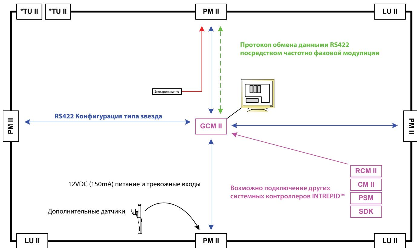
\* При конфигурации звезды и обмене данными посредством частотно фазовой модуляции требуется модули TU
