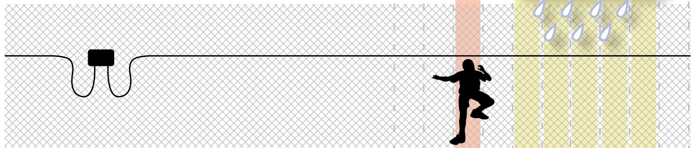
Когда происходит воздействие на ограждение, полученный от сенсорных элементов сигнал создает образ колебания ограждения. Цифровая обработка сигнала (DSP) измеряет местоположение и форму этого импульса. Микропроцессор может различать сигнал при попытке разрезать ограждение или перелезть его от сигнала, вызванного пробочными факторами (дождь, снег, транспорт).
