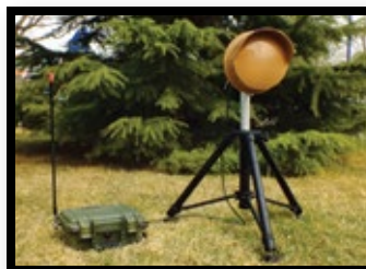
385 RDS ОДНОПОЗИЦИОННЫЙ МОБИЛЬНЫЙ РАДИОЛУЧЕВОЙ ДАТЧИК
